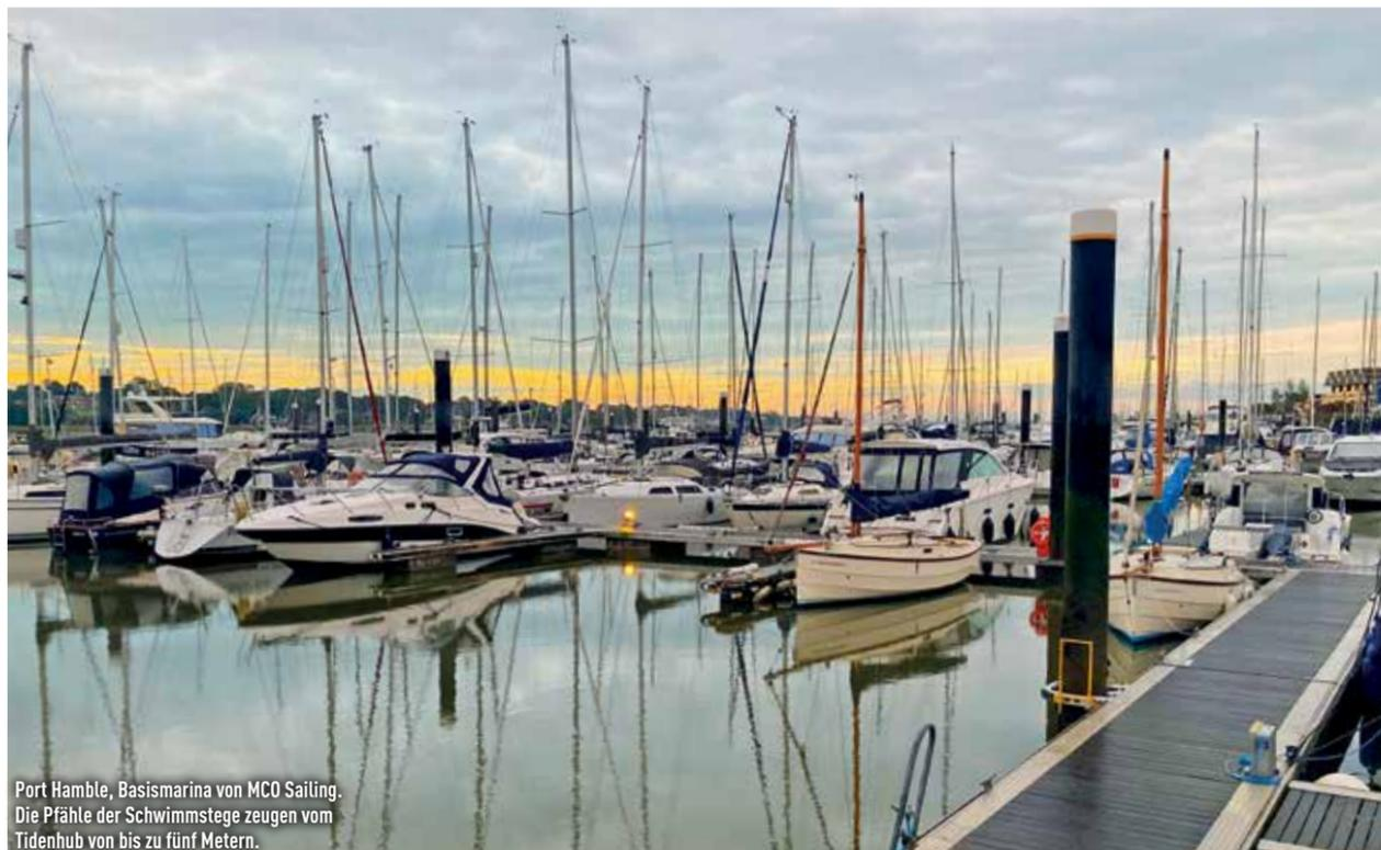
Port Hamble, Basismarina von MCO Sailing. Die Pfähle der Schwimmstege zeugen vom Tidenhub von bis zu fünf Metern.
