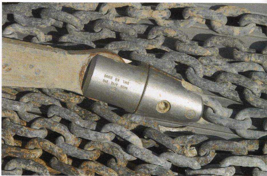
*Moderne drehbare Verbindung Kette–Anker.*
