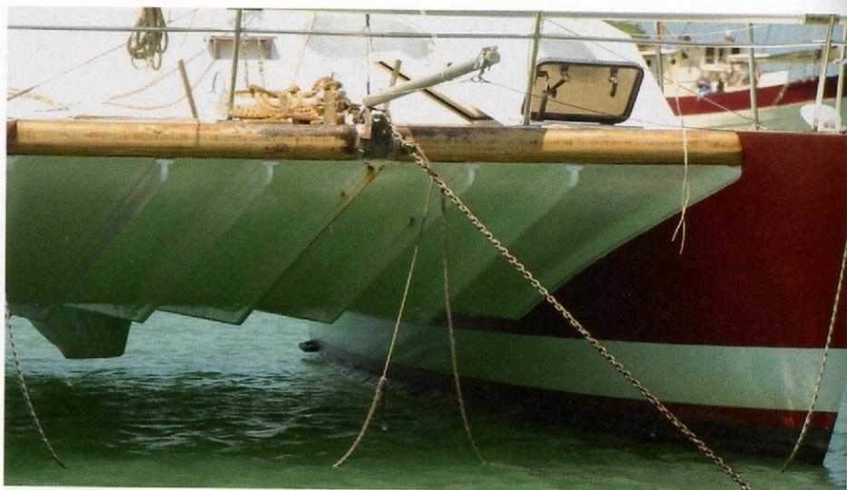
*An diesem Katamaran sind bereits zwei (zweckentfremdete) Schoten an der Kette angeschäkelt. Wird nunmehr die Kette nachgelassen, bis die Schoten als Entlastungsleinen zum Tragen kommen, bilden sie einen Hahnepot, an dem die Ankerkraft ansetzt.*
