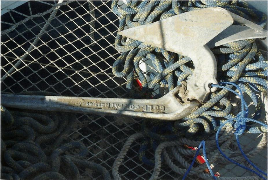
*Hier ist eine blaue SchwimMLEINE als Tripleine am Anker angebracht. Sie kann – im Gegensatz zur Ankertrosse – unbedeutend dünn sein.*
