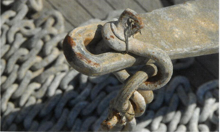
Ein Moneldraht sichert den Schäkel gegen das Losdrehen des Bolzens. Aber Achtung, Verletzungsgefahr!
