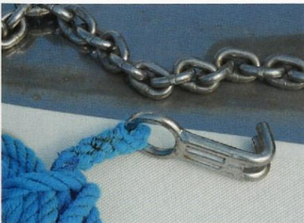
*Praktischer als die Befestigung mittels Schäkel ist die Kettenkralle, auch Teufelskralle. Sie kann ohne Hilfsmittel an Ankerketten eingeklinkt werden ...*
