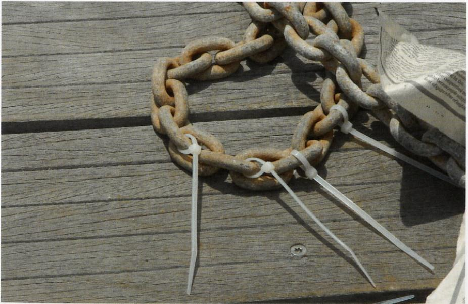
*Ohne die Codierung mittels Kabelbinder hier zu kennen, könnte sie »40 Meter« bedeuten ...*
