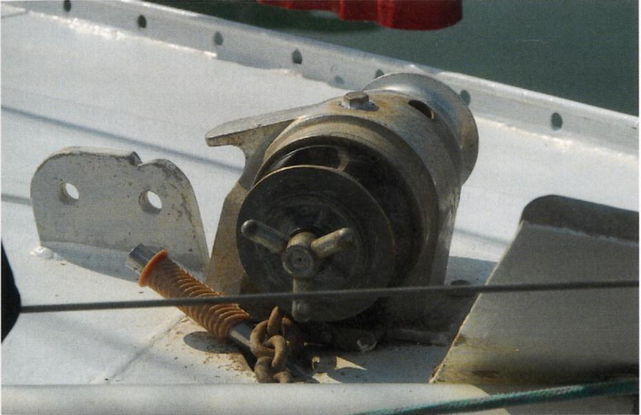
*Hand-Ankerwinde auf einer 11-Meter-Metallyacht. Der Stock wird neben der Seiltrommel eingesteckt, und mittels Hin- und Herbewegen wird die Winde – langsam – bewegt.*
