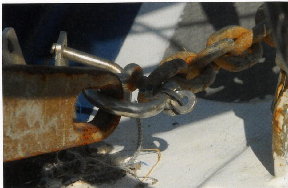
*Ein Kabelbinder zur Sicherung des Schäkels sollte bei jedem Ankerauf-Manöver gecheckt werden, weil diese praktischen Dinger nicht unempfindlich gegen mechanische Belastungen sind.*
