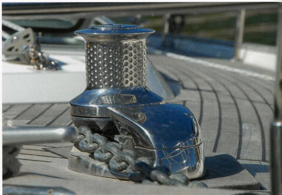
*Diese elektrische Ankerwinde mit senkrechter Achse eignet sich gleichermaßen für Kette und Trosse.*
