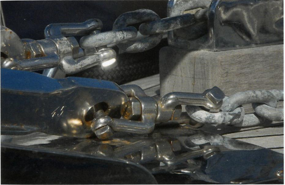
*Ein Wirbelschäkel gleicht die Verdrehung der Kette aus, wenn sich eine Yacht um die eigene Achse dreht.*
